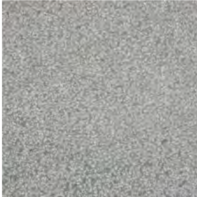
ΜΑΡΜΑΡΙΝΗ ΠΛΑΚΑ ΑΠΟΧΡΩΣΗΣ ΓΚΡΙ “ΤΥΠΟΥ ΔΕΜΑΤΙΟΥ – ΜΕΤΣΟΒΟΥ” πάχους 5 εκ.
